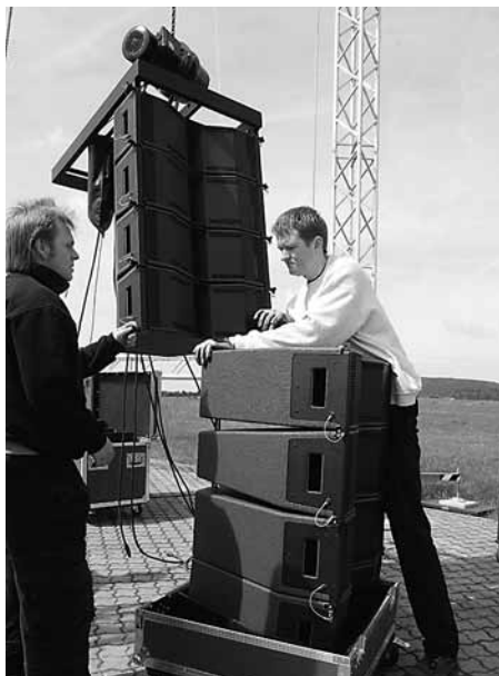
Abbildung 16: Hochfahren der oberen vier COHEDRA® Mid/ High Boxen
