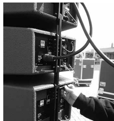
Abbildung 9: Einstellen der Curving-Winkel im Flug
