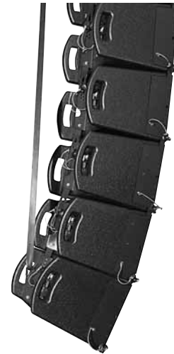
Abbildung 19: Einhängen des Zurringurtes
