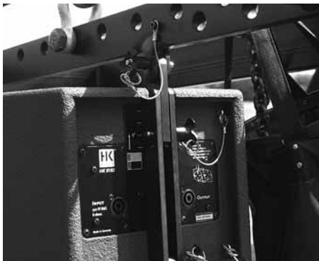
Abbildung 2: Mid/ High Box mit integrierter Flugmechanik
