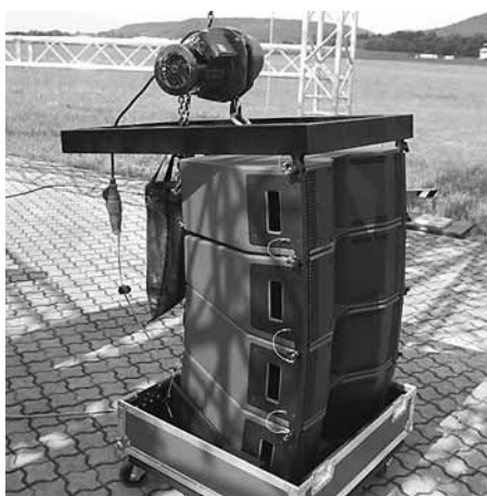
Abbildung 14: Einhängen des Haupt-Motors am oberen Flugrahmen
