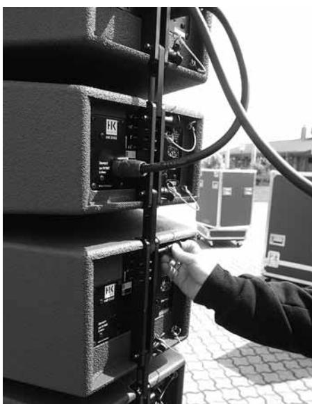
Abbildung 15: Einstellen der Curving-Winkel zwischen den COHEDRA® Mid/ High Boxen
